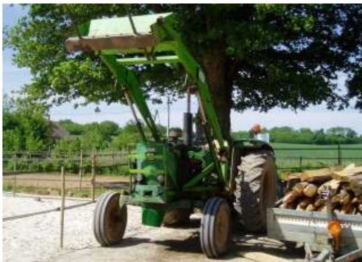
Kuva 4. Kuvan traktoria nuori työntekijä ei saa kuljettaa, sillä siinä ei ole vaadittua turvaohjaamo. (Heikkinen 2008).
